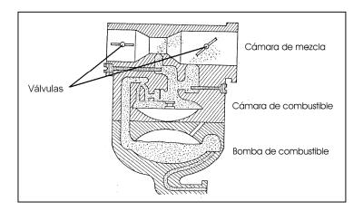
El carburador lleva en su cuerpo dos tornillos de regulación del paso de la mezcla hacia el cilindro, denominados tornillo de alta y tornillo de baja, los que están marcados con una letra H y L, respectivamente. De acuerdo al modelo del carburador es posible que dichas letras estén marcadas en su cuerpo.
