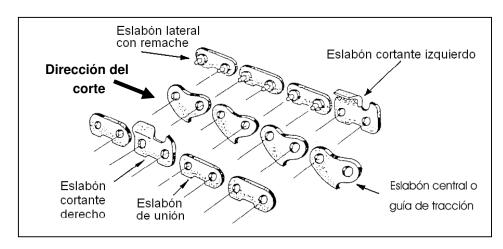
Un buen afilado y mantenimiento de la cadena contribuyen con la eficiencia de la motosierra. Una cadena sin filo y con mantenimiento escaso requiere más tiempo, combustible y esfuerzo para trabajar. Además se desgasta rápidamente y se puede dañar la espada, el piñón e incluso el motor.
