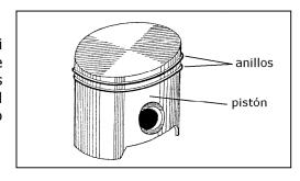
En su recorrido hacia arriba comprime a la mezcla combustible y, cuando ésta explosiona por la chispa que aporta la bujía, el pistón es expulsado hacia abajo generando el impulso que, a través del eje cigüeñal y de la biela, finalmente mueve a la cadena, transformando el movimiento alternativo en rotativo.
