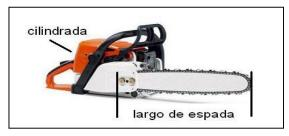
El uso de espadas de mayor tamaño implica un incremento bastante importante de peso del equipo y un aumento en la potencia requerida para operarlo.
