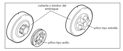
La fuerza que recibe el piñón es transmitida a la cadena mediante el encaje de los eslabones guías en sus dientes o ranuras.
