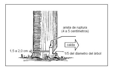
De ninguna forma es recomendable recortar la arista de ruptura, porque se pierde el control sobre la dirección de caída del árbol.
