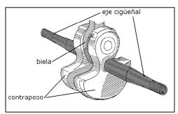
Normalmente se fabrican de aleaciones capaces de soportar los esfuerzos a los que se ven sometidos y pueden tener perforaciones y conductos para el paso de lubricante.
