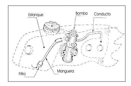
Para la lubricación de la cadena se debe emplear aceite de buena calidad. No se puede usar aceite quemado, porque además de producir desgaste prematuro de la espada y de la cadena tapa los conductos de la bomba de aceite.
