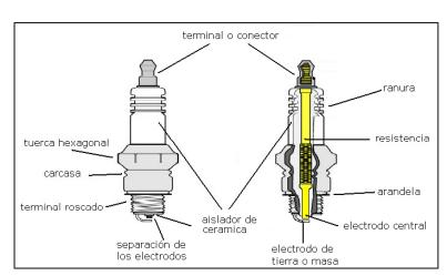
Soporta temperaturas extremas, que pueden superar los mil grados. Está constituida por las partes que se indican en la figura.
