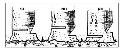
En la separación, entre los cortes horizontales debe quedar un espacio de madera al tocón, con un ancho de entre 4 a 5 centímetros, que permite controlar la dirección de caída del árbol. Este ancho puede ser mayor en caso que el tronco presente pudrición en su interior, o el árbol este inclinado y comprima la madera. Si no ésta puede fácilmente romperse, permitiendo al árbol mecerse de atrás hacia adelante y cambiar su dirección de caída.
