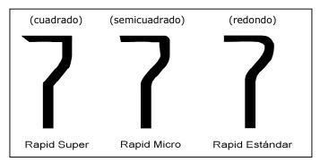
El diente cortante, a su vez, tiene tres ángulos, denominados de corte, de ataque y de estabilización. Estos ángulos vienen dados por el fabricante y deben mantenerse durante toda la vida útil de la cadena, a través del afilado.
