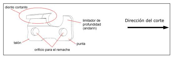
El limitador de profundidad también es llamado **andarín** o **diente botador**, porque junto con determinar la profundidad de corte tiene la función de arrastrar el aserrín.
