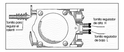
Además, existe otro tornillo denominado de ralentí, utilizado para regular el paso del aire a la cámara de mezcla.
