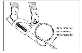
En un tronco o árbol suspendido, el corte se efectúa entre dos apoyos. Por lo tanto, cuando tiene la curvatura hacia abajo el lado superior está sometido a compresión y el lado inferior a tracción. Lo inverso ocurre cuando la curvatura está hacia arriba.
